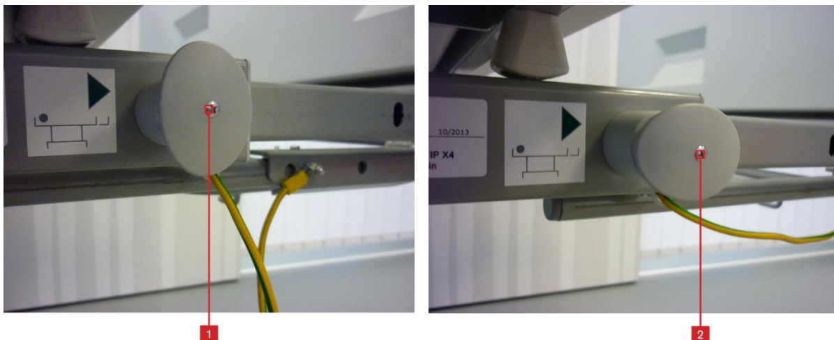
Fig. Blocco di sicurezza dell'estensione del piano rete.
