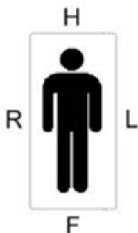
Fig. Etichetta sulle componenti del piano rete (H = testa, F = piede, R = destra, L = sinistra)
