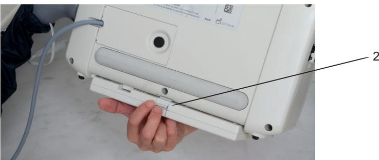
Fig. 22 Rimozione del gruppo batteria
